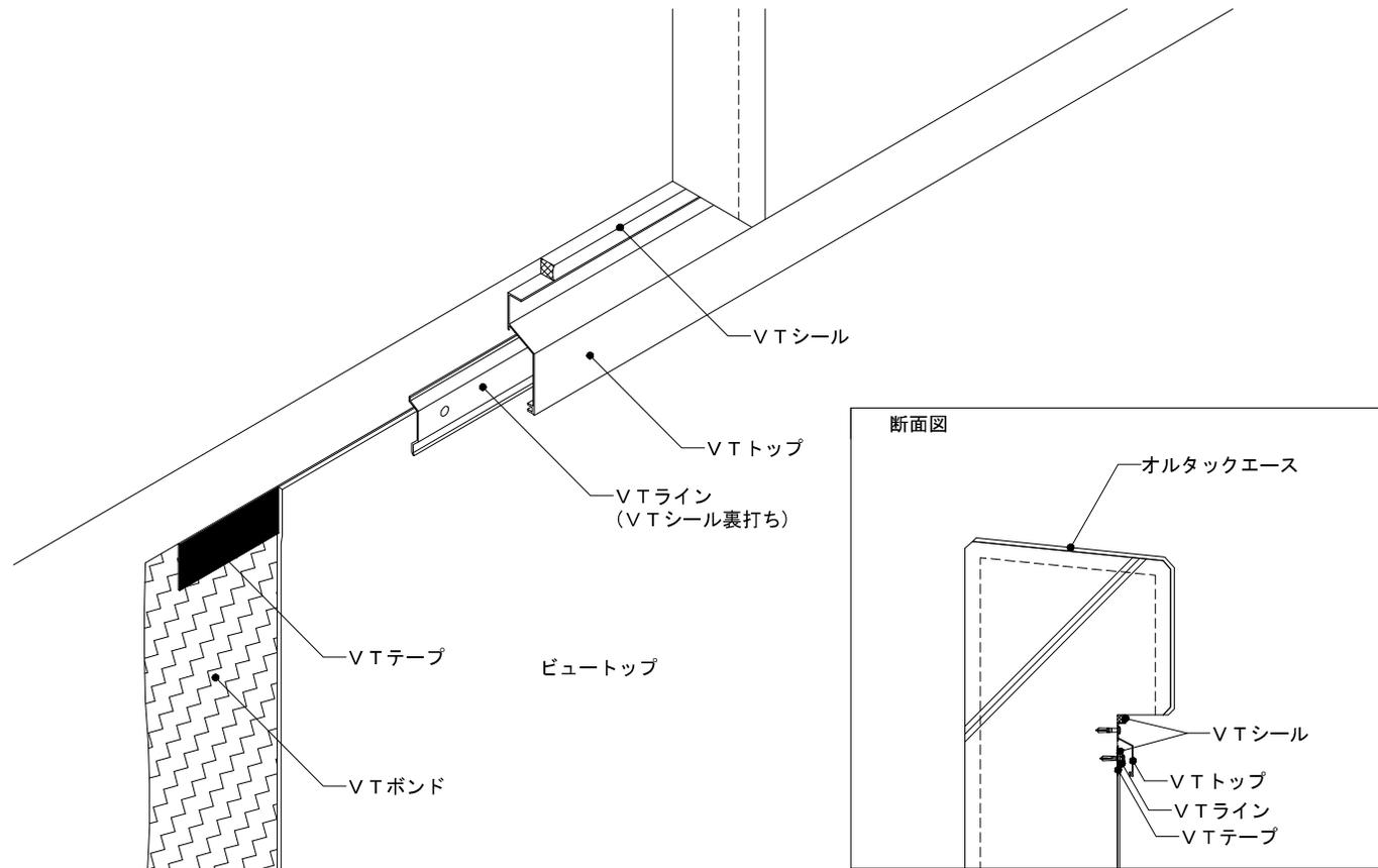
立上り：機械的固定工法 水切り目地有り
