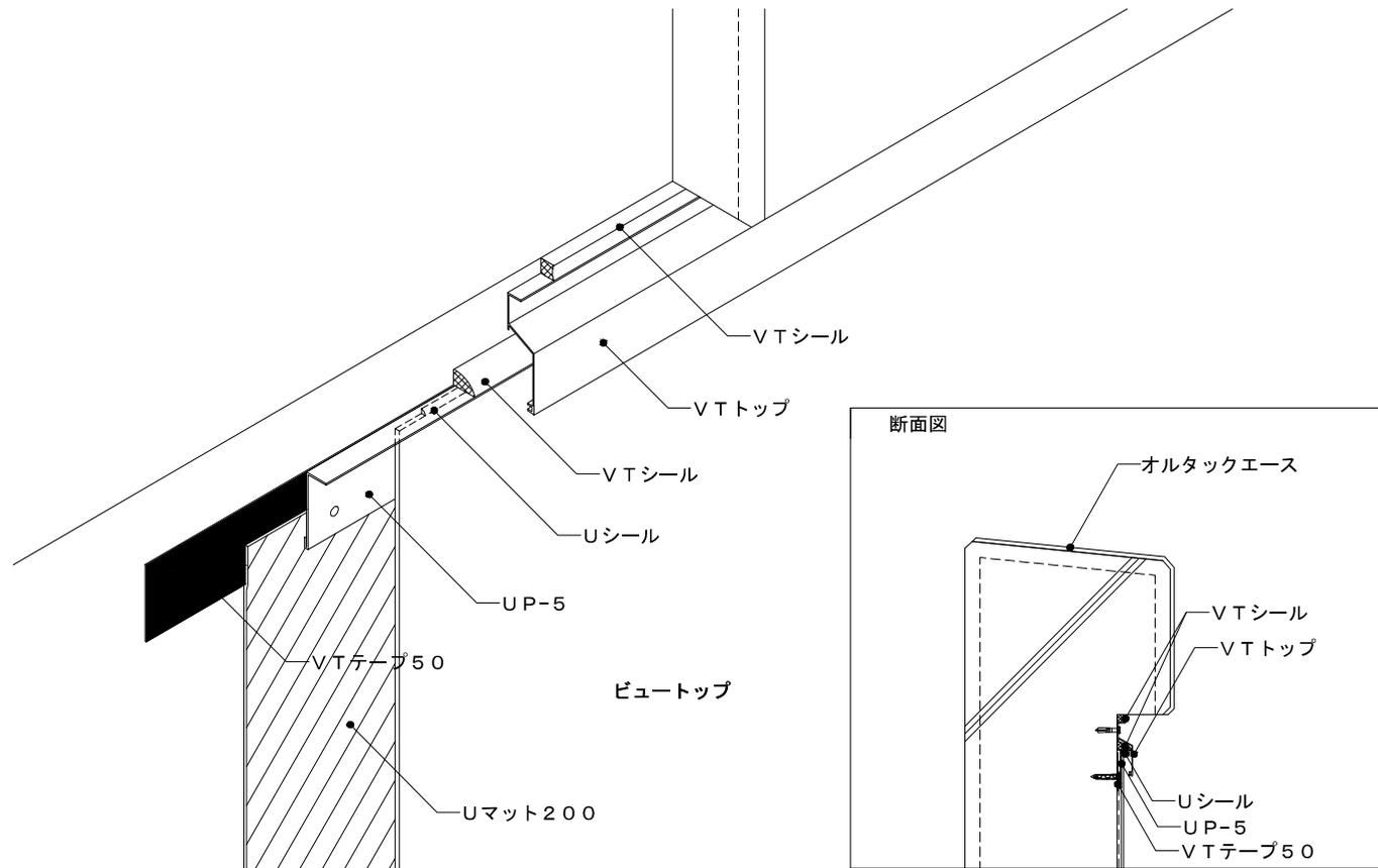
壁立上り：接着工法 水切り目地無し
