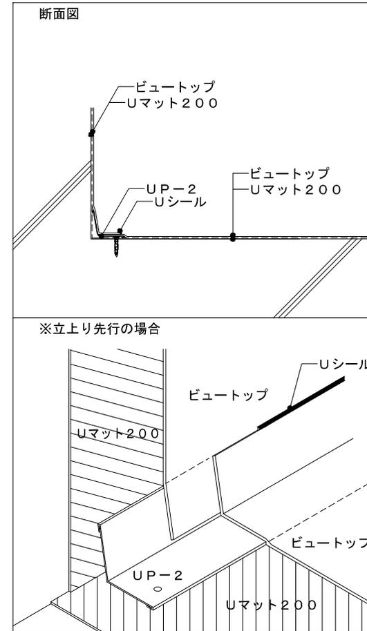
平場：断熱機械的固定工法 立上り：接着工法
