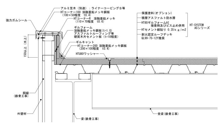
パラペット 流れ方向/鉄骨立上り
